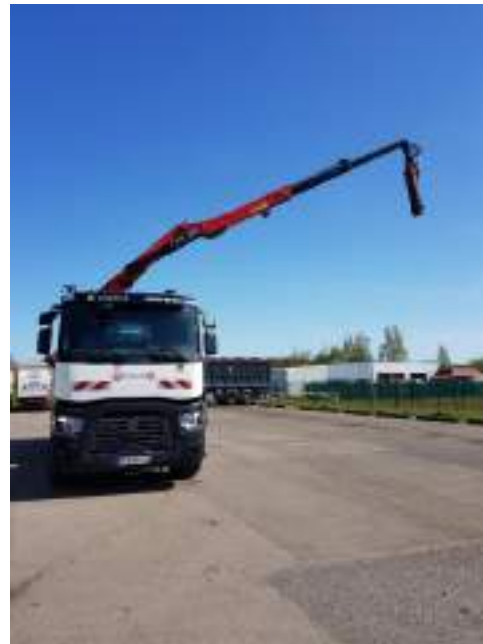
Hauteur Flèche déployée en hauteur = 8,50 m
