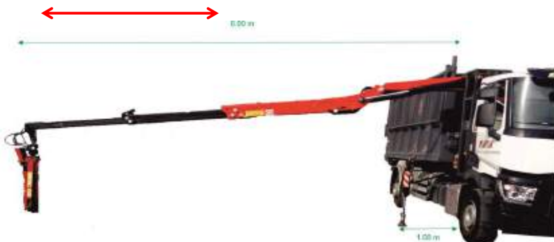
Largeur nécessaire avec stabilisateurs déployés = 3,9 mètres
